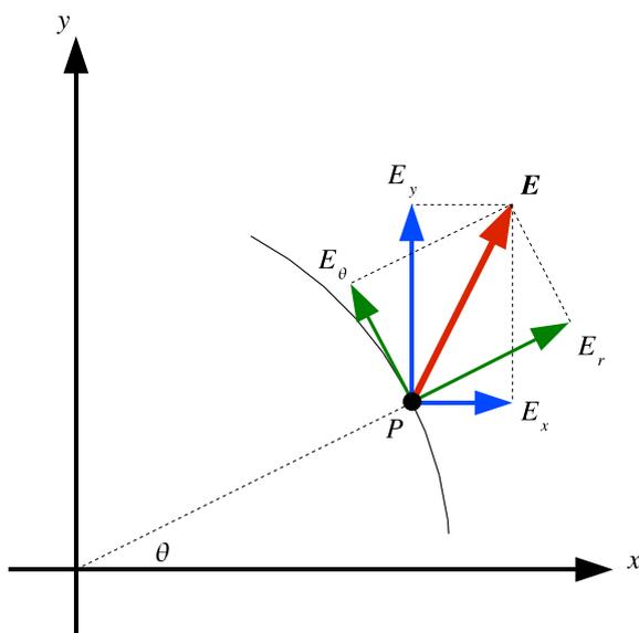
図 1: 2次元のカーテシアン座標と極座標系での電場
